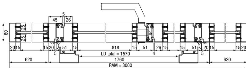
Corte horizontal puerta Loft de acero de 2 hoja(s) con fijos laterales
